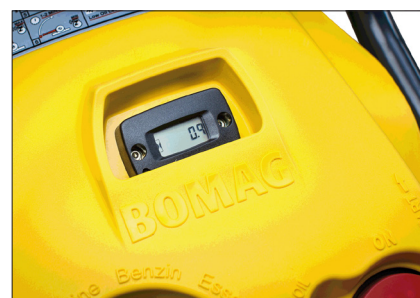
Compteur d'heures/tachymètre avec affichage de l'intervalle d'entretien
