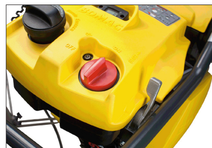
Moteur et alimentation en carburant avec interrupteur mixte
